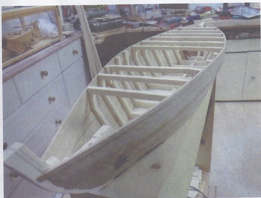
Das Spanten-Gerüst im Entstehungs-Prozess
